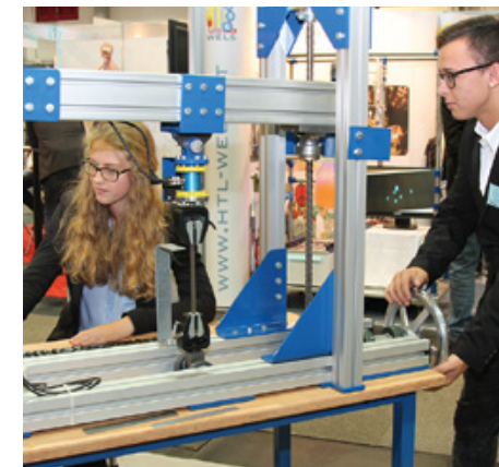
Schülerinnen und Schüler des LiTEC demonstrieren auf der Berufsinformationsmesse in Wels den Zugversuch. Bild: LiTEC
