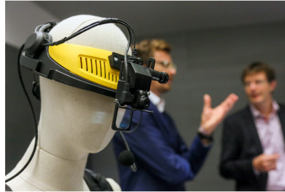
Knapp WebEye – ein tragbares und industrietaugliches Display- und Computersystem – minimiert über Live-Video-Support die Instandsetzungszeiten, erhöht somit die Anlagenverfügbarkeit und spart Reisekosten.
