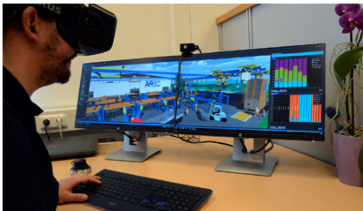
Komplexe Abläufe werden von AREC virtuell in der Entwicklungsphase mit eigens entwickelten Simulationswerkzeugen getestet. Bild: AREC Automationstechnik GmbH
