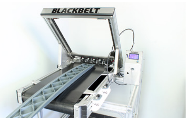
3D-Druck am laufenden Band. Ein Fördergurt ermöglicht die Produktion von endlosen Bauteilen. Bild: Blackbelt 3D BV
