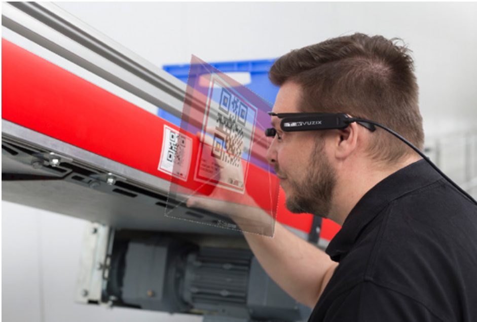
Mittels QR-Code hinterlegte Informationen zur Anlage kann der Techniker einfach vor Ort abrufen. Bild: TGW
