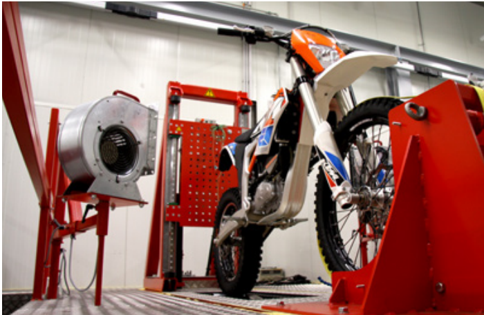
Am neuen Prüfstand kann nun auch ein Gesamtfahrzeug getestet werden. Bild: IMA
