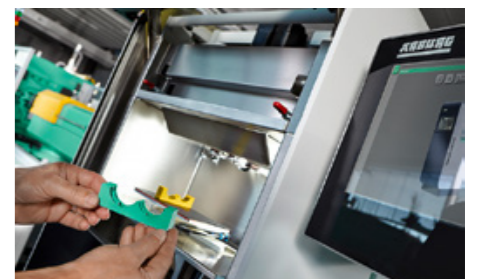
Besonderes Verfahren der additiven Fertigung: Der freeformer von Arburg fertigt das Bauteil auf Basis von 3D-CAD-Daten aus kleinsten Tropfen. Bild: ARBURG
