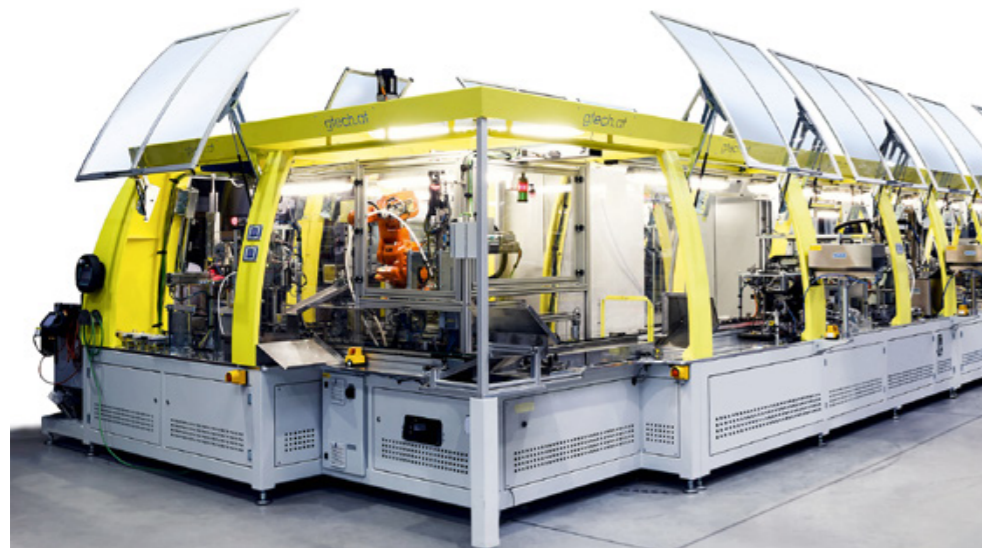
In dieser vollautomatisierten Montageanlage werden für einen deutschen Automobilhersteller im 18 Sekunden-Takt Wasserpumpen montiert. Bild: GTech
