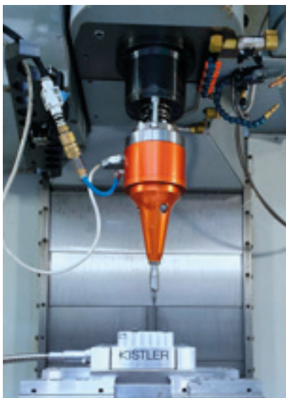
Versuchsaufbau: Drei-Achs Bearbeitungszentrum mit Aktor zur mechanischen Oberflächenbearbeitung Foto: TU Wien
