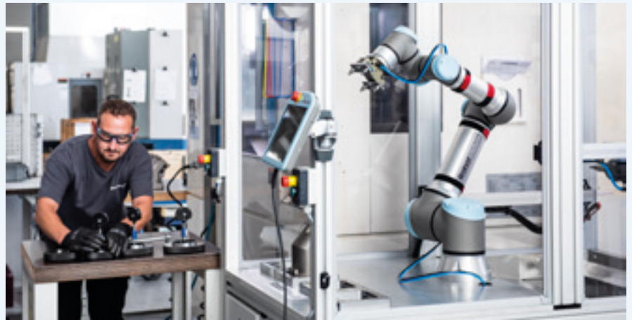
Der neue UR16e kann mehrere Werkstücke bis 16 kg gleichzeitig heben. Foto: Universal Robots
