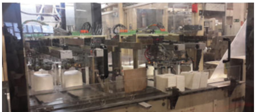
Die bestehende Mechanik der Serviettenübergabe wurde in die neue Regelungstechnik implementiert. Foto: Spörk
