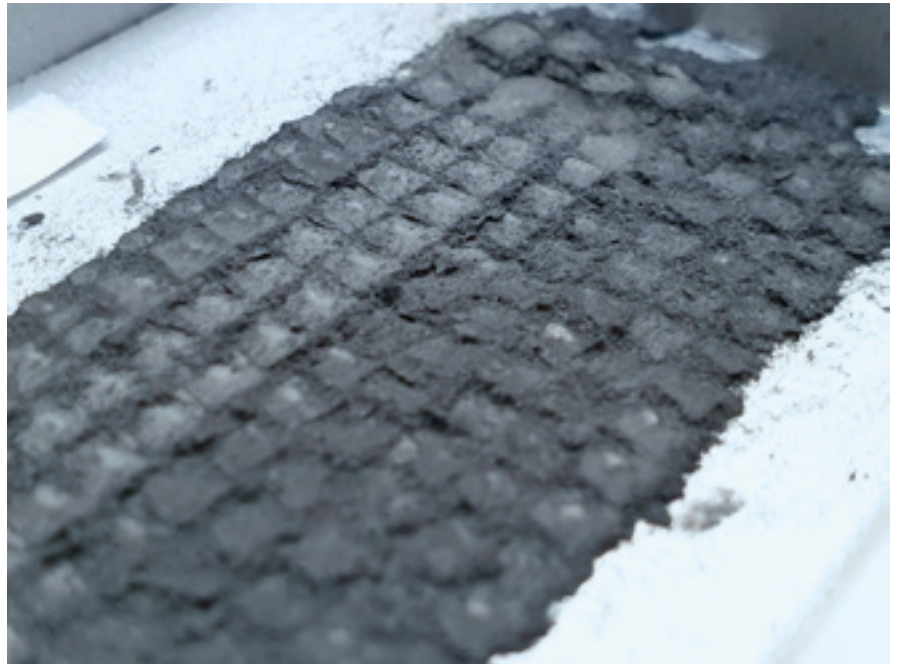
Proof of concept: Schichtweiser Aufbau von WC-Co unter Anwendung des Aktors Foto: TU Wien
