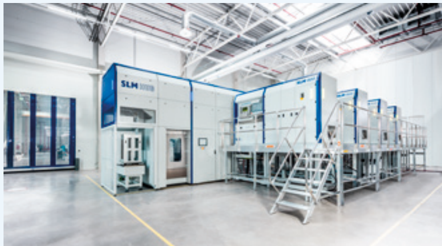
SLM@800 Multi-Maschinen-Setup für die industrielle, additive Fertigung von der SLM Solutions Group AG. Foto: MostTech/SLM Solutions Group AG
