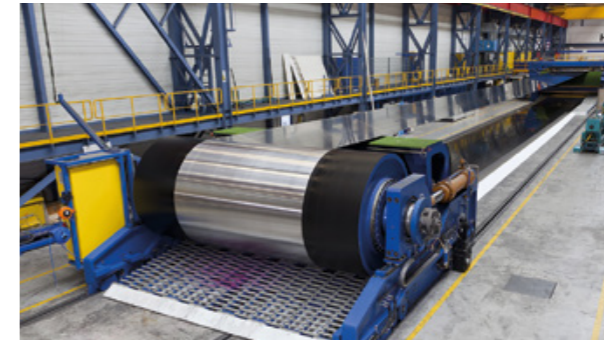
Produktion eines endlosen Stahlbandes für die Herstellung von Holzbasisplatten. Bild: Berndorf Band
