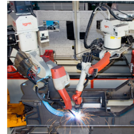
„Vorrichtsloses Schweißen“: Der Handlingroboter holt die Setzteile von einer Palette und platziert sie positionsgenau auf dem Werkstück, wo sie vom Schweißroboter angeheftet werden. Für das Positionieren der Setzteile sind keinerlei Vorrichtungen erforderlich.
