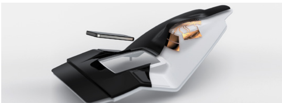
Vorprojekte wie „sensitive_surface“, bei der die Oberfläche zur Navigation durch die Bedienebenen des Bordcomputer verwendet wird, lieferten wertvolles Know-how. Das Projekt 3D-MEOD baut nun darauf auf. Bild: ISP
