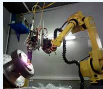
Eine Laserprozesszelle beim Laserauftragsschweißen Foto: LaserTec
