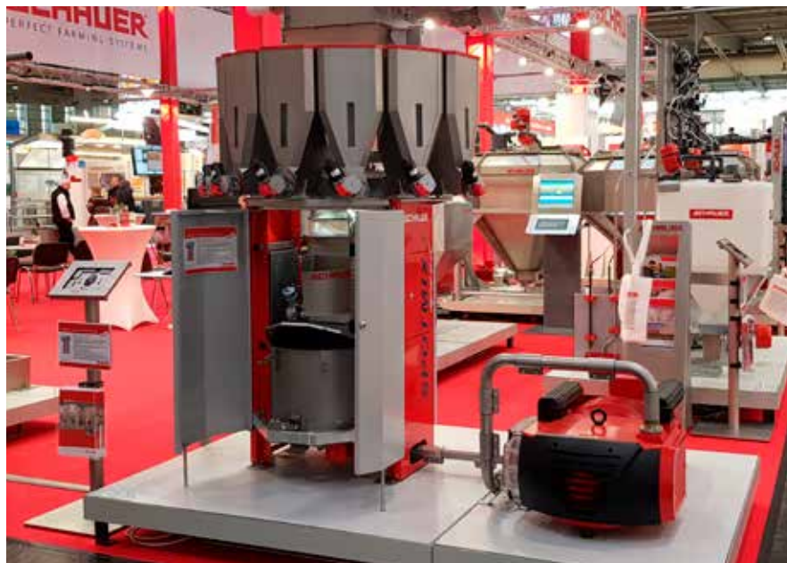
Das automatisierte Fütterungssystem „Spotmix“ mischt das Futter für jedes Tier im Stall individuell zusammen. Foto: Schauer Agrotronic GmbH
