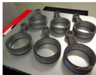
Additiv gefertigte Testkörper. Foto: IFT - Institut für Fertigungstechnik und Photonische Technologien
