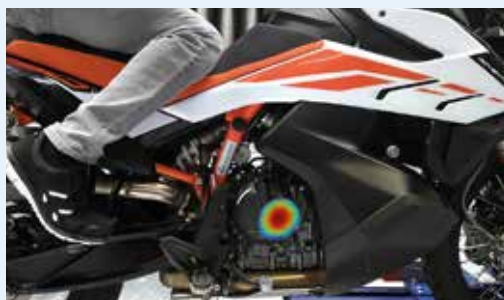
Visualisierung der Geräuschquellen eines Motorrads. Bild: Seven Bel GmbH
