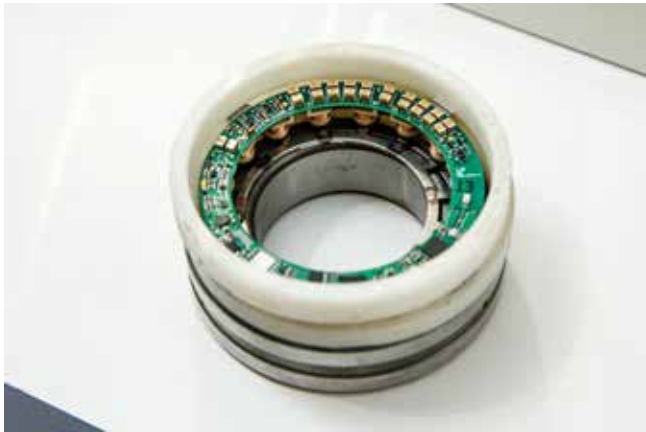
Noch unvergossen und ungeschützt: der Modular-Sensor samt Metallring, Spulen, Kondensatoren als Energiespeicher, Temperatursensoren, Mikrokontroller und Antenne. Dahinter der Reluktanzring und das Wälzlager von NKE. Bild: Hermann Wakolbinger/LCM
