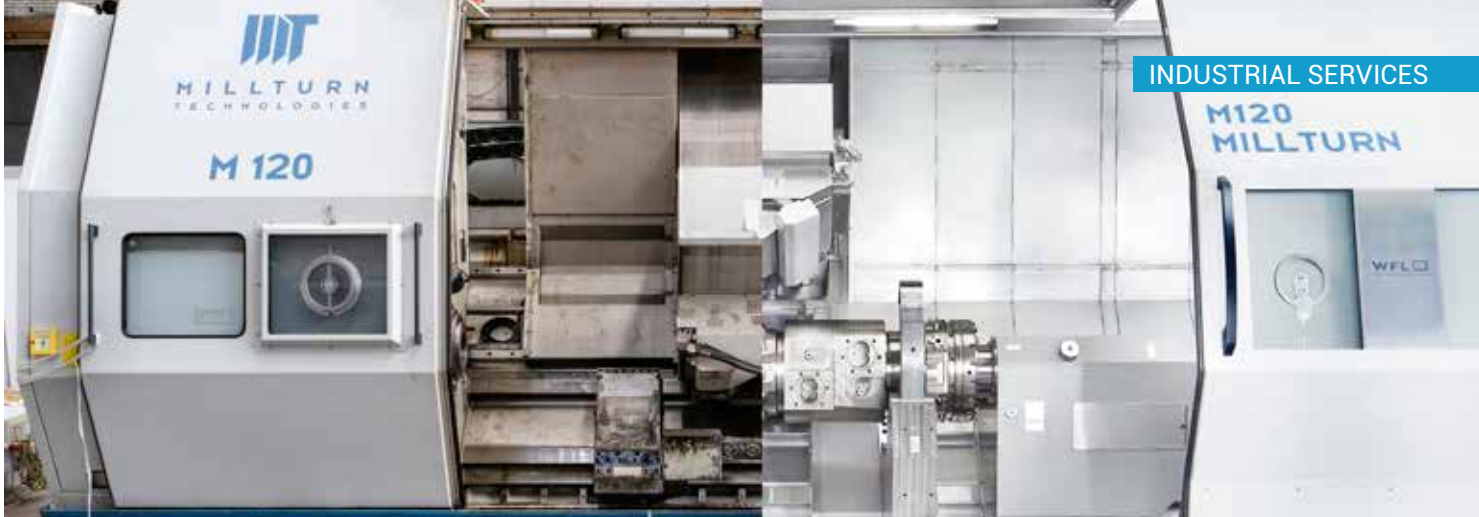
RETRO-FIT einer M120 MILLTURN: links das Modell vor der Generalüberholung durch WFL, rechts nach dem Retrofit. Bild: WFL Millturn Technologies GmbH & Co. KG
