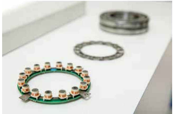
Die runde Leiterplatte und ein Metallring mit Zapfen, auf denen insgesamt 16 Spulen sitzen, bilden den Modular-Sensor. Unschärf dahinter der Reluktanzring und das Wälzlager von NKE. Bild: Hermann Wakolbinger/LCM
