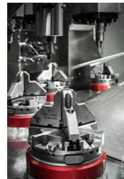
Entkoppelte Werkstückträger garantieren höchste Präzision in jedem Bearbeitungsschritt.
