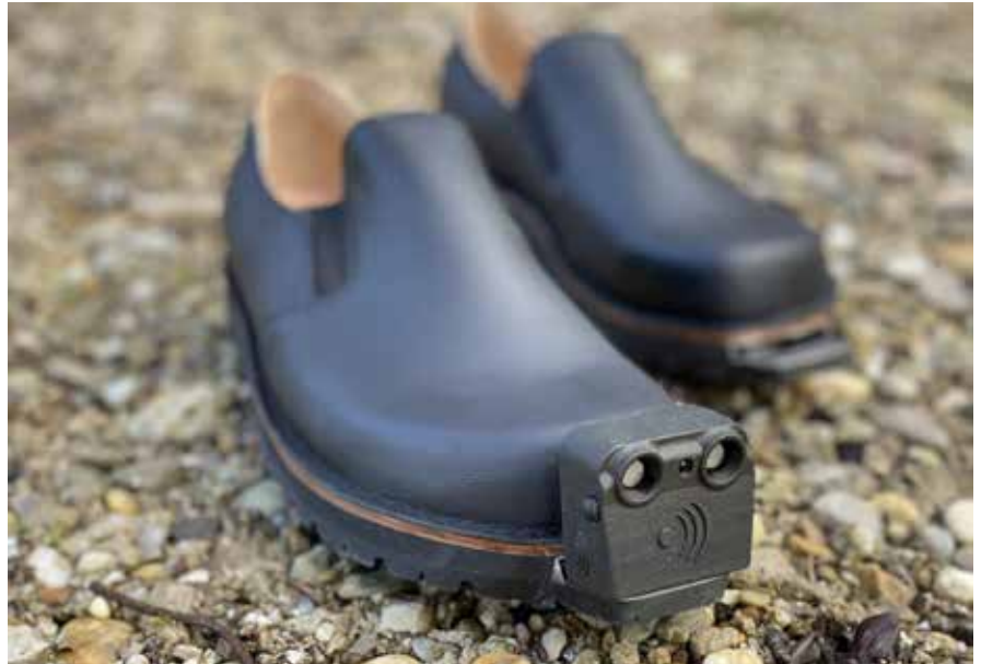
Ultraschallbasierter InnoMake Schuh von Tec-Innovation zur intelligenten Hinderniserkennung Bild: Tec-Innovation GmbH
