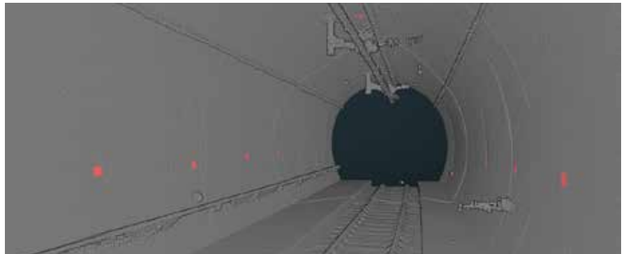
Darstellung einer Punktwolke, die über das Projekt-Framework geladen werden kann. Bild: FH St. Pölten
